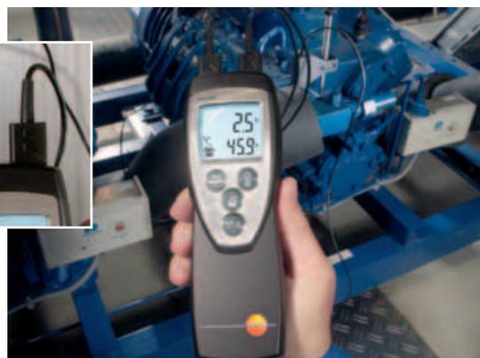
Control de la temperatura diferencial en compresores con las sondas abrazadera de tubería
