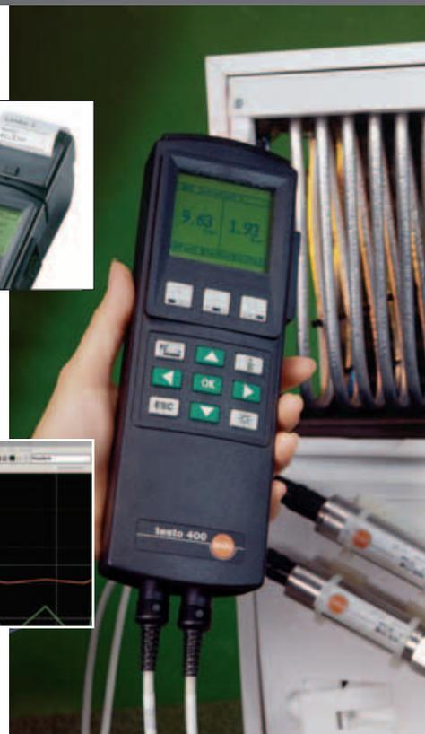
Medición de la presión alta/baja en un sistema de refrigeración
