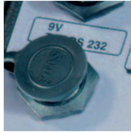
Entrada de sonda °C (testo 556/560), intercambio de datos con el ordenador (testo 560), conexión de un chip de memoria externo (testo 556)
