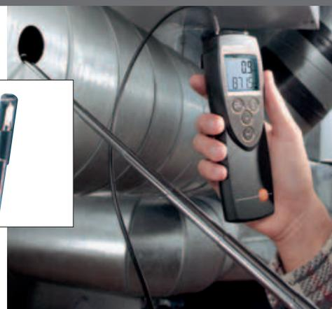
Control de la velocidad en conductos de aire acondicionado
