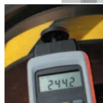
Medición de rpm sin contacto (óptico)
