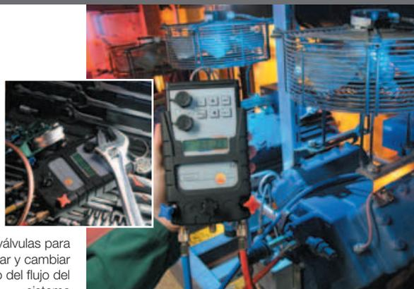
Bloque de válvulas para evacuar, llenar y cambiar el recorrido del flujo del sistema
