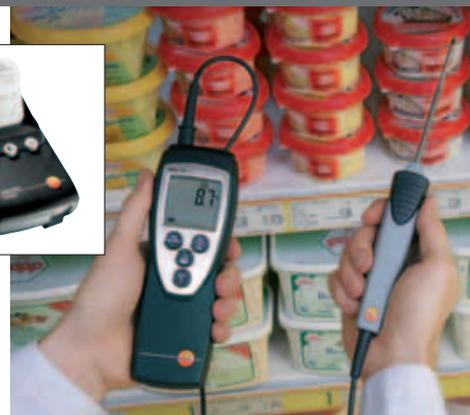
Inspección de un mostrador refrigerado para averiguar si dispone de suficiente refrigeración
