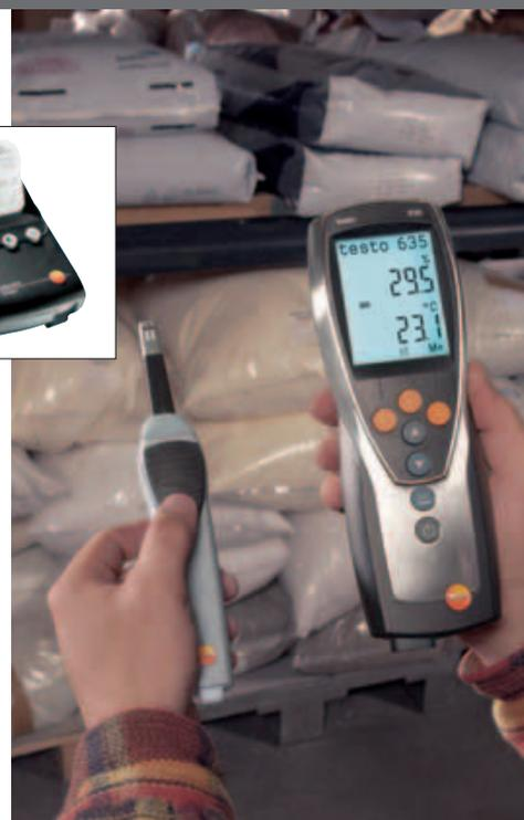
Medición sin cables de la temperatura y la humedad en un almacén, con empuñadura por radio y sonda acoplable de humedad
