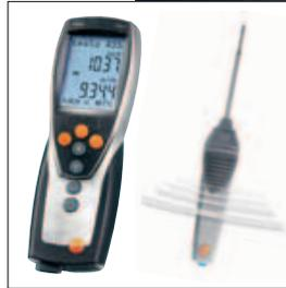
Medición inalámbrica con sondas por radio para medición ambiente y por inmersión/penetración
