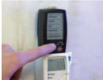
El testo 580 recoge datos in situ para descargar al PC y analizarlos
