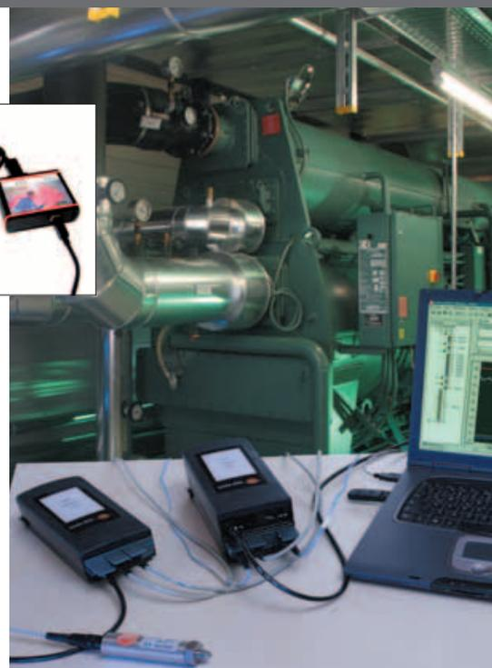
Medición del recalentamiento/subenfriamiento y la presión del combustible en un sistema de refrigeración industrial
