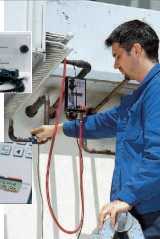
Medición del subenfriamiento con una sonda de velcro
