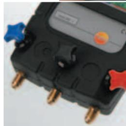
Bloque de válvulas, presión de aspiración, presión alta, llenado, vaciado
