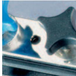
Válvula de sobrepresión para el sensor de vacío (testo 560)
