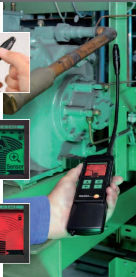
Detección de fugas rápida y precisa en sistemas de refrigeración y bombas de calor
