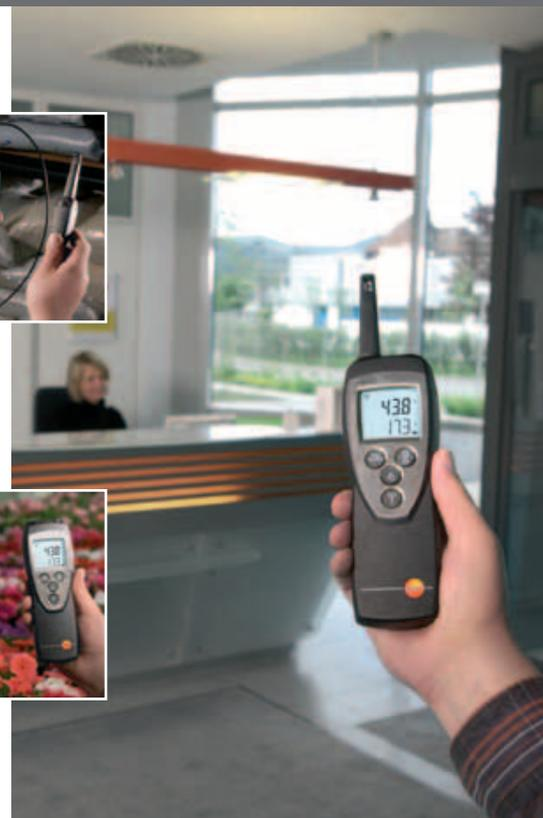
Control del ambiente en interiores con sonda de humedad integrada
