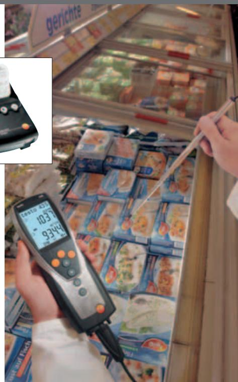
Control de la corriente del aire en un armario refrigerado
